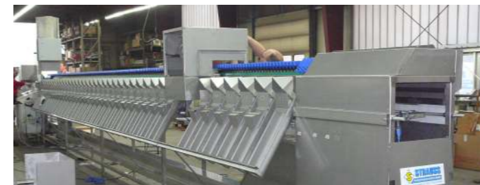
Tapas retentoras: nuestro software de clasificación averigua el peso de sus espárragos por medio de un cálculo volumétrico. Las salidas presentan tapas retentoras que se abren cuando se alcanza el peso de envase preestablecido y pasan el espárrago a la cubeta colectora.
