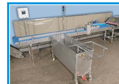
Recipientes de suspensión previos a la cinta alimentadora para simplificar la incorporación de los espárragos desde la caja y sistema de cinta posterior a la instalación para juntar y evacuar de la cortadora los restos de corte
