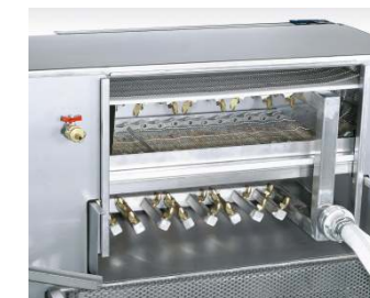
Si los espárragos que quiere clasificar son sucios, es necesario de lavarlos a través de la cinta escurridor de abajo y de arriba por válvulas especialmente concebidas
