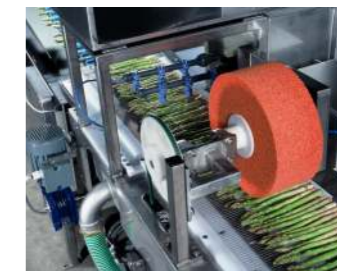
Unidad lavadora pequeña: La versión pequeña de la unidad lavadora es suficiente si sus espárragos son bastante aseados después de la cosecha. Esta unidad pre-cortadora y lavadora compacta ha sido desarrollada especialmente para lavar todos tipos de inmundicias del espárrago verde
