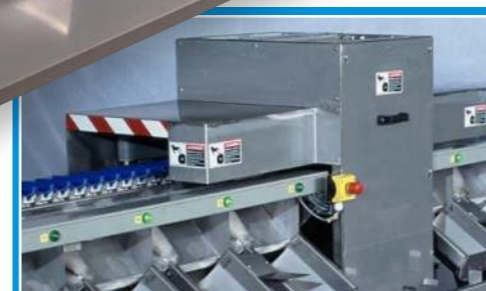
Opcional: unidad de corte adicional sobre la instalación para cortar los espárragos a una longitud preestablecida
