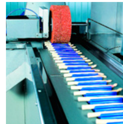
De asperge wordt op een variabele lengte gericht en hierop afgekort met een speciaal hiervoor geslepen mes.
