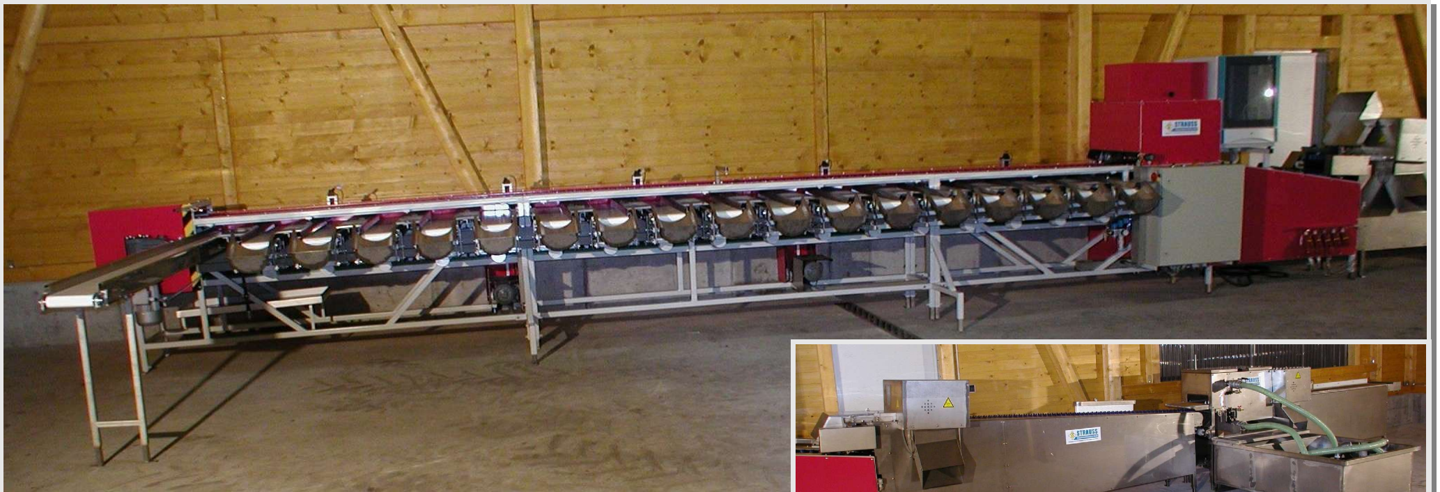
Sortieranlage mit 18 Ausgängen
